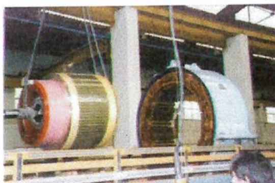
Figura 5-11.:Embarque de conjunto armadura e estator de D32-
